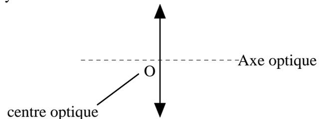
Le centre optique O est l'intersection de la lentille avec l'axe optique.
